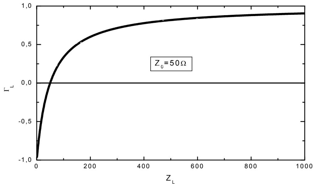
Observa-se que o sinal refletido pode apresentar tanto polaridade positiva quanto negativa em relação ao sinal original. Havendo "descasamento" de impedâncias, a potência do sinal refletido retorna à fonte e nela é dissipada, podendo em alguns casos ser suficiente para danificar seu estágio de saída.
