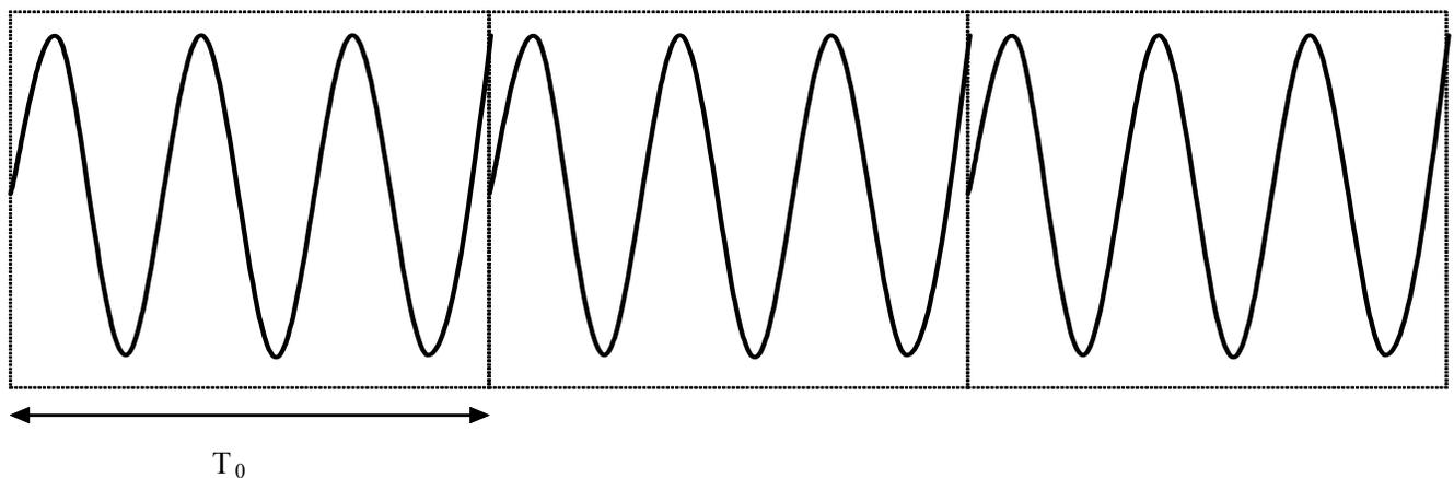
Estas distorções se apresentam como um alargamento do espectro original (*spectral leakage*), devido ao alto conteúdo harmônico contido nas transições abruptas.
