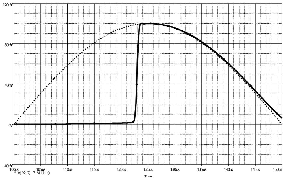
Figura 9: Gráfico de  $v_o$  no semiciclo negativo para uma frequência de 5 kHz, SR de 0,5 V/μs e alimentação simétrica de 5 V.
