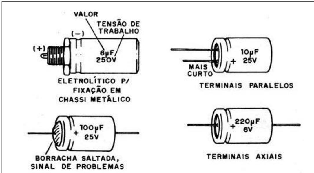
Figura 7: Principais elementos dos capacitores Eletrolíticos
