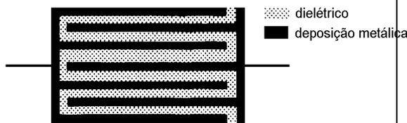
Figura 3 Esquema de construção de capacitores "multicamadas".
