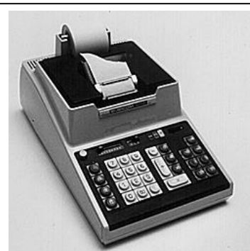
A calculadora Busicom de 1970, empregando o microprocessador Intel 4004.
