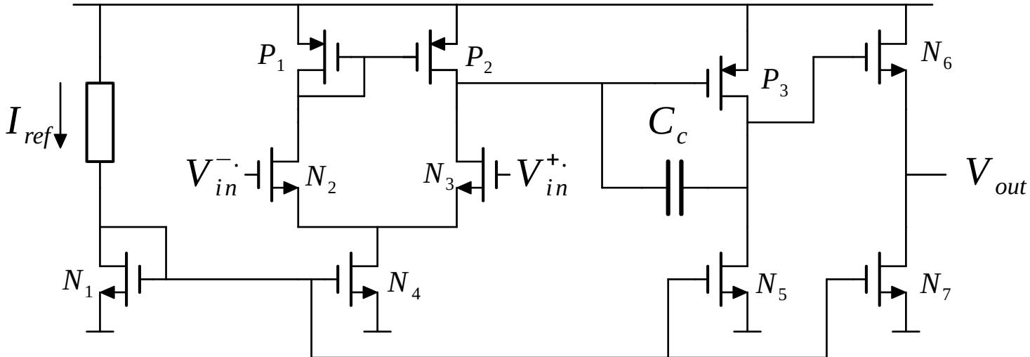
Obter  $R_{in}$ ,  $R_{out}$  e  $Av_0$  do amplificador operacional
